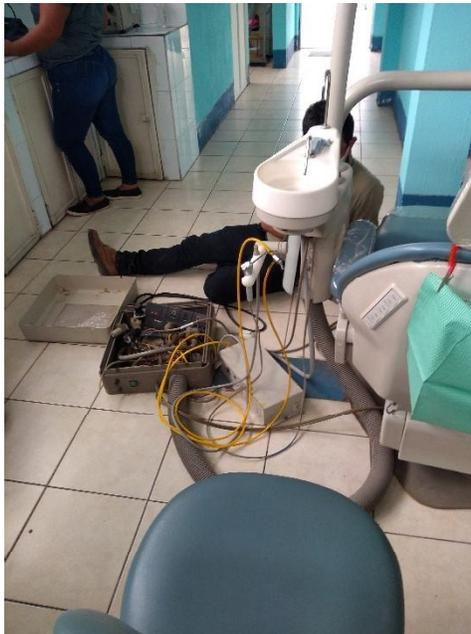
Mantenimiento, reparación y revisión de mangueras con arreglo de fugas de la unidad dental.
