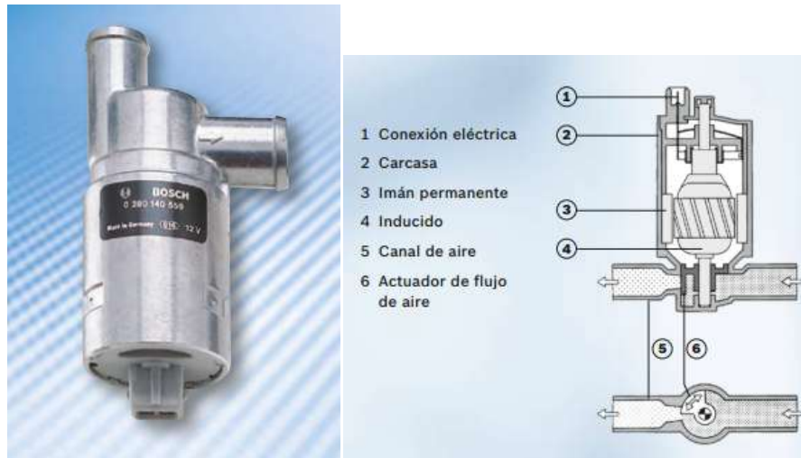
Figura 13. Actuador de ralentí
