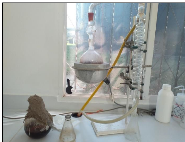
Figura No. 25. Destilación de la muestra para ácidos volátiles.
