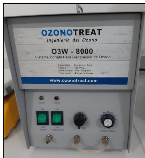
Figura No. 18. Aparato Generador de Ozono
