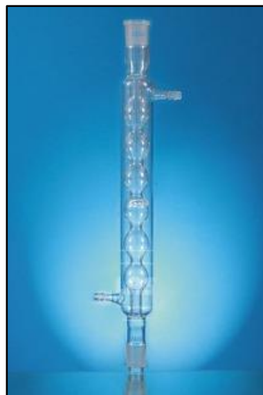
Figura No. 16. Tubo destilador Fuente: Fonseca, 2019.
