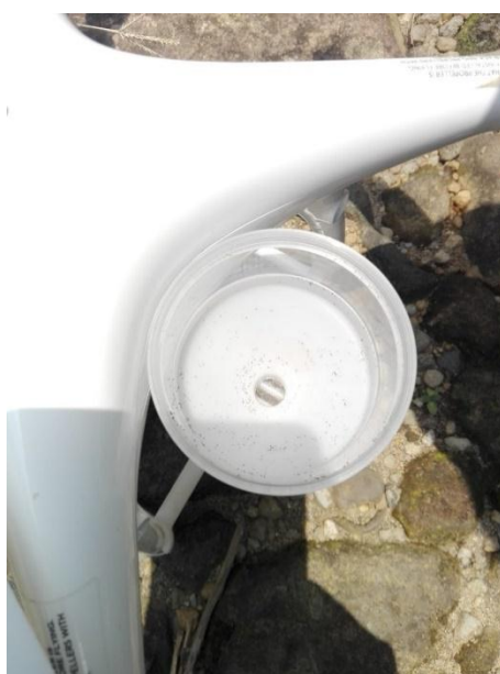
Figura 24. Compartimiento de Bio-bot vacío después de la liberación.
