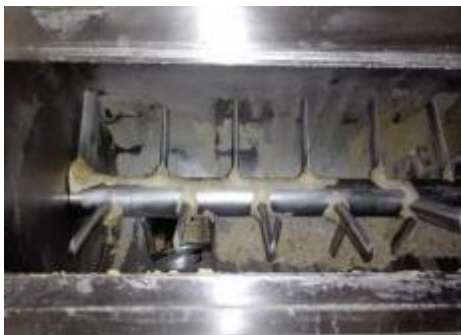
Figura 10. Eje paletero distribuidor
