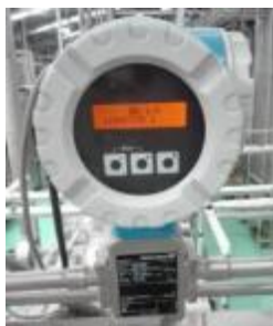
Figura 43. Medidor de flujo
