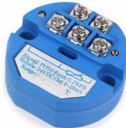
Fuente: Elkon. Transmisor de Temperatura RTD PT100 4-20mA 2 hilos 0 a 200°C 24V.
