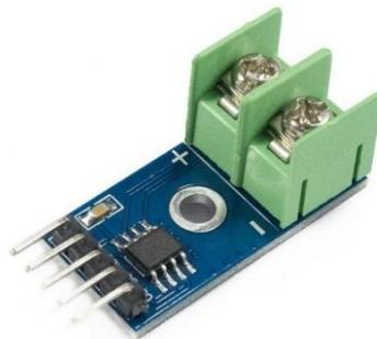
Fuente: TRANSMISOR PARA TERMOCUPLA K MAX6675. Consultado el 30 de diciembre de 2021. Recuperado de <https://naylampmechatronics.com/sensores-temperatura-y-humedad/331-transmisor-para-termocupla-k-max6675.html>.
