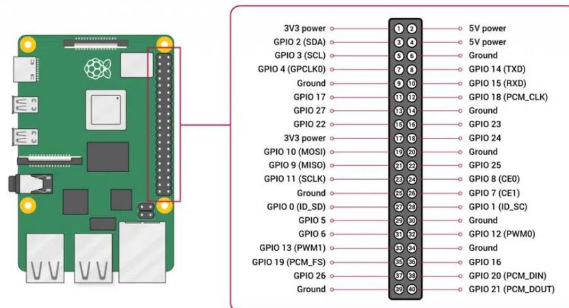
Fuente: Hardware Libre. GPIO: todo sobre las conexiones de la Raspberry Pi 4 y 3. Consultado el 26 de diciembre de 2021. Recuperado de <https://www.hwlibre.com/gpio-raspberry-pi/>.
