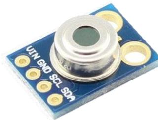
Fuente: Electrónica DIY. Sensor de Temperatura Infrarrojo GY-906. Consultado el 29 de diciembre de 2021. Recuperado de [https://www.electronicadiy.com/products/sensor-de-temperatura-infrarrojo-gy-906?\\_pos=6&\\_sid=cafebcf3&\\_ss=r](https://www.electronicadiy.com/products/sensor-de-temperatura-infrarrojo-gy-906?_pos=6&_sid=cafebcf3&_ss=r).
