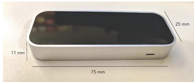
Figura 10. Dimensiones del controlador Leap Motion
