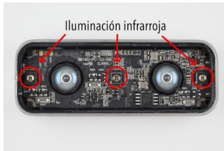
Figura 12. Iluminación infrarroja dentro del dispositivo
