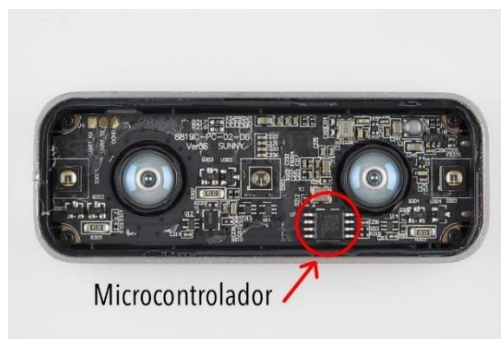
Figura 13. Ubicación del microcontrolador en el Leap Motion
