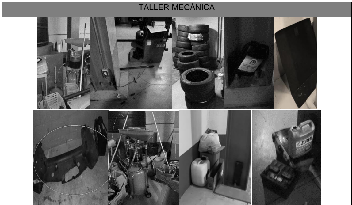
Figura 44. Falta de 5S en taller mecánico
