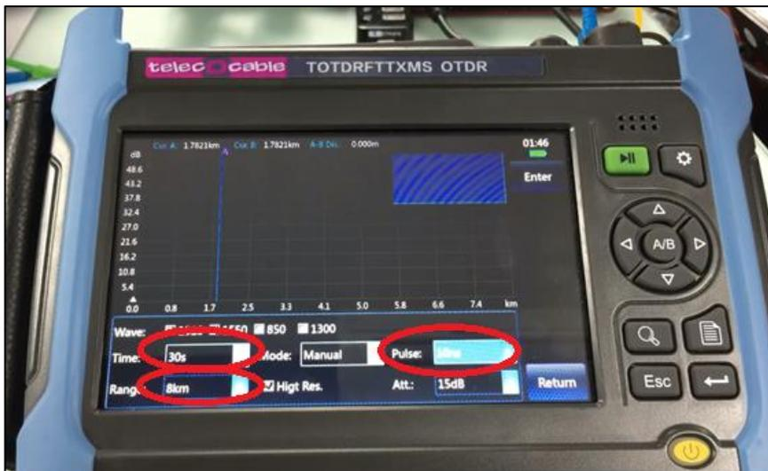
Fuente: Equipos de medición. *Configuración de OTDR.*
