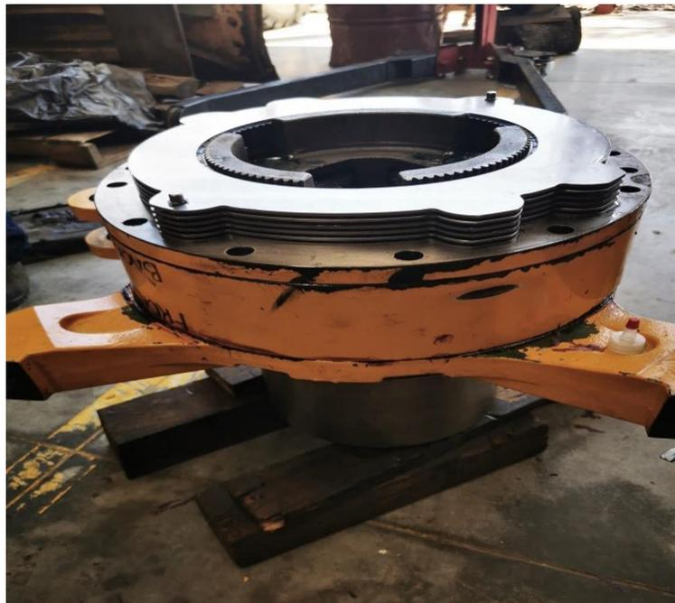
Fuente: Grupo JM S.A. Sistema de freno motoniveladora John Deere 670G.
