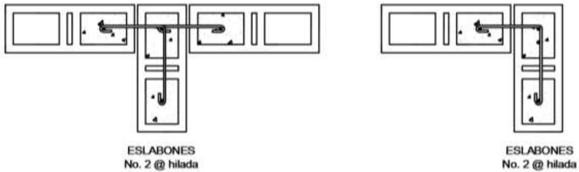
Figura 28. Detalles de armado de refuerzo vertical
