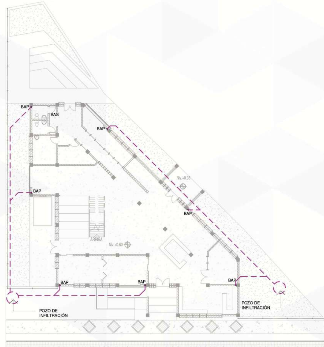
PISO 01 - ESQUEMA DRENAJE PLUVIAL 1 : 300
