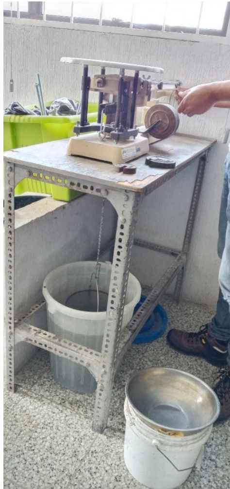
Figura 24. Inmersión del agregado grueso para la determinación de la masa del cuerpo sumergido
