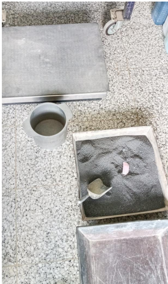
Figura 25. Material y equipo utilizados para la determinación de masa unitaria del agregado fino
