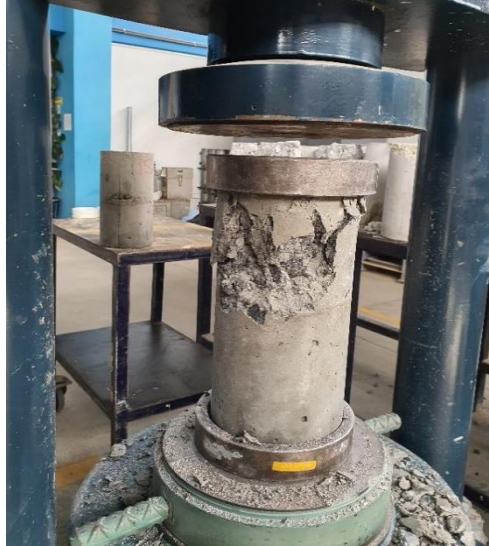
Figura 53. Muestra cilíndrica de concreto con falla de tipo 6
