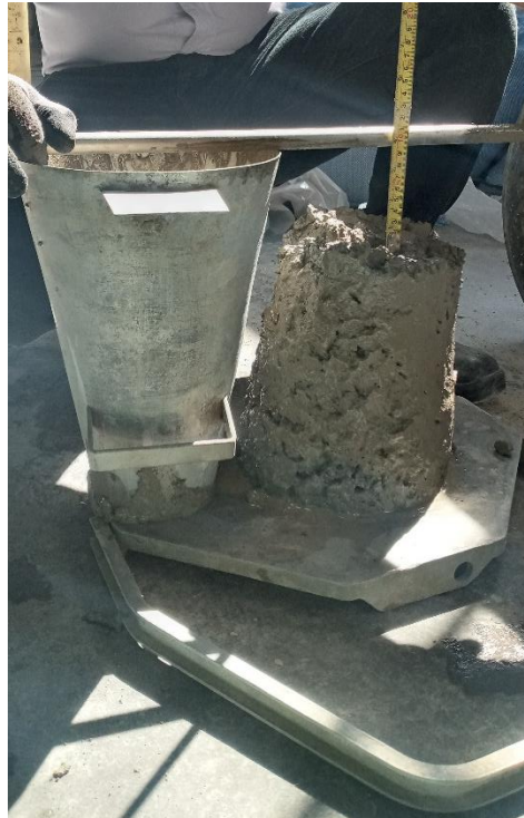
Figura 28. Determinación del asentamiento del concreto recién mezclado
