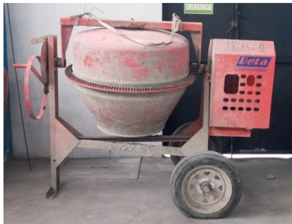
Figura 26. Mezcladora de concreto del Centro de Investigaciones de Ingeniería
