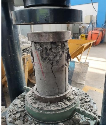
Figura 55. Muestra cilíndrica de concreto con falla de tipo 6
