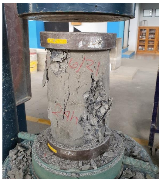
Figura 54. Muestra cilíndrica de concreto con falla de tipo 2
