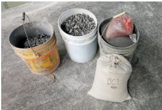
Figura 32. Agregado grueso, agregado fino y cemento pesados para una mezcla de concreto
