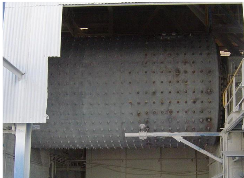
Figura 4. Molienda de materias primas en molino de bolas
