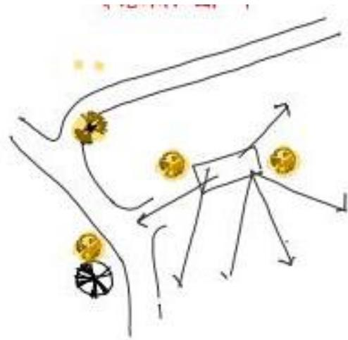
Los corrales deben contar con pasillos de protección para circulación de los empleados y productores paralelos a los pasillos de circulación del ganado.
