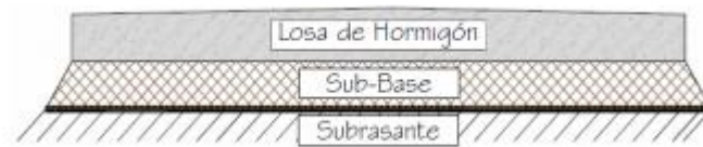
Figura 4. Sección típica transversal de un pavimento rígido
