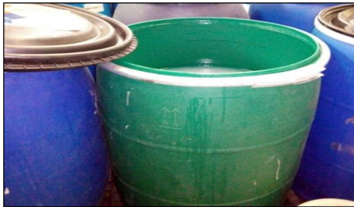
Figura 36. Producto químico no resguardado y mala manipulación
