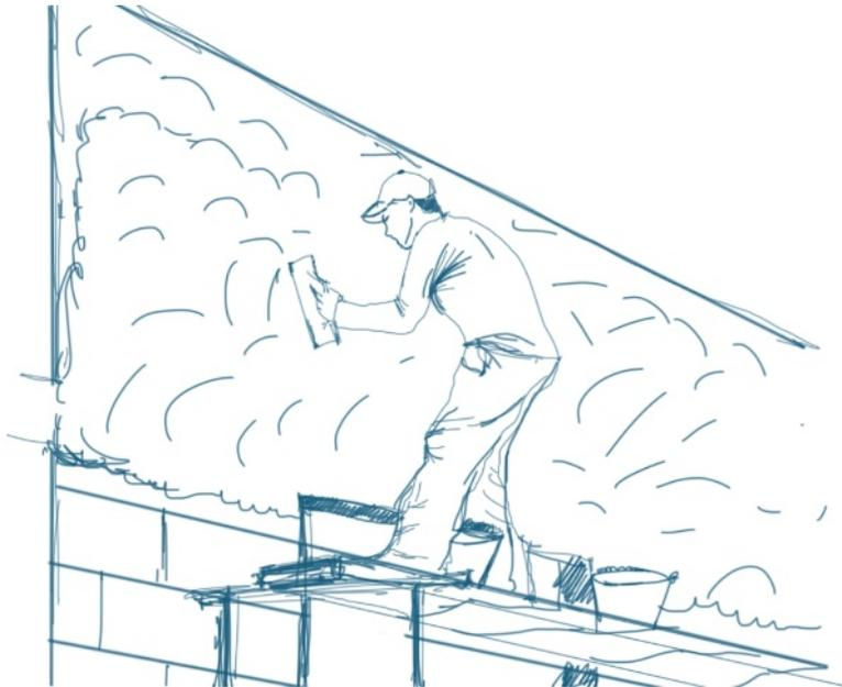
Ilustración 38 Aplicación de acabado cementicio sobre superficie. Fuente: Elaboración propia
