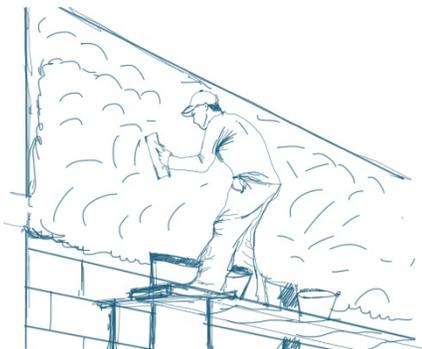
*Ilustración 30 Aplicación de acabados sobre muro. Fuente: Elaboración propia*
