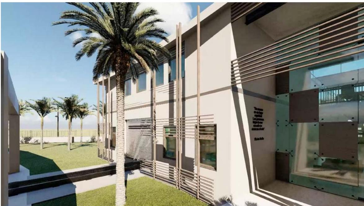
Parteluces en fachada de edificio de integración (edificio nuevo).
