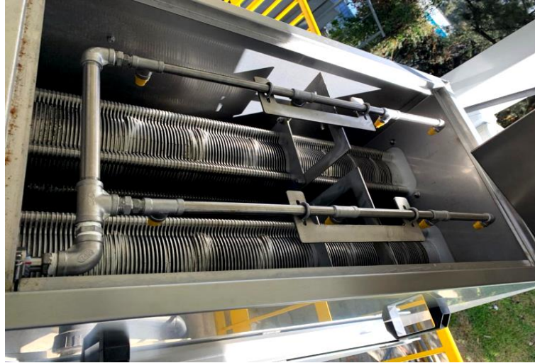
Figura 7. Interior de un tornillo deshidratador
