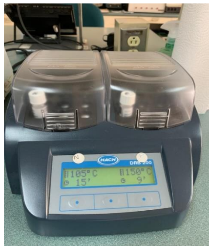
Figura 10. Reactor Hach medición DQO
