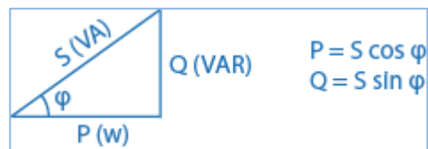
Figura 7. Ecuaciones de potencia en función de los catetos del triángulo de potencia
