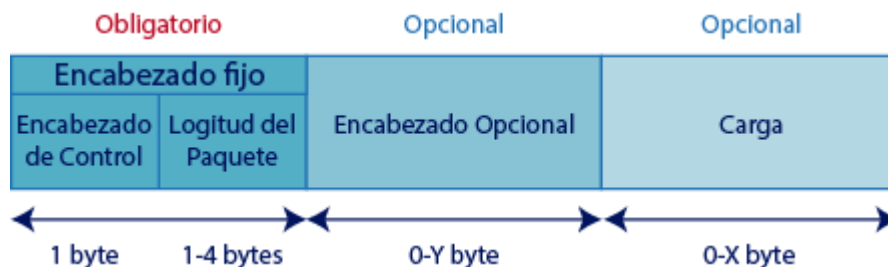
Figura 16. Estructura de un mensaje MQTT
