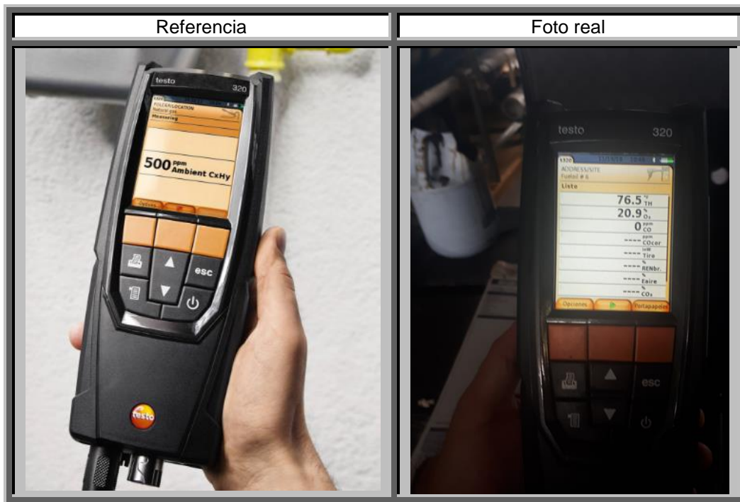
Figura 11. Analizador de combustión Testo 320
