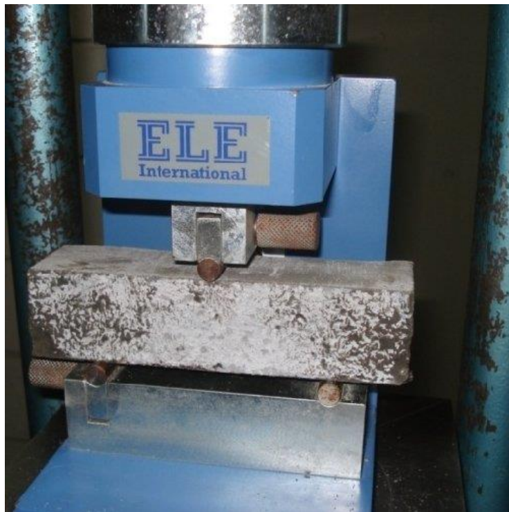
Figura 8. Ensayo a flexión en vigas
