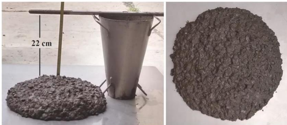
Figura 7. Revenimiento con mezcla de concreto que no cumple con normas de ensayo
