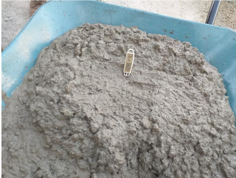
Figura 12. Diseño teórico de mezcla de concreto con aditivo de caucho
