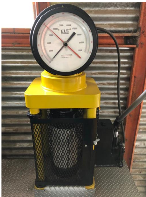
Figura 14. Ensayo a compresión
