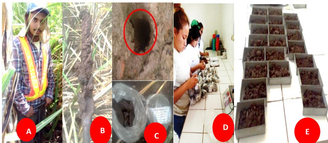
**Figura 13.** Procedimiento para la obtención de la humedad del suelo por el método gravimétrico, A: Utilización de barreno helicoidal. B: Obtención de muestra de suelo. C: Muestra de suelo colocada en bolsas de nylon, se etiquetan y trasladadas a laboratorio. D: Se pesan las muestras de suelo. E: Se colocan en bandejas y se introducen al horno.
