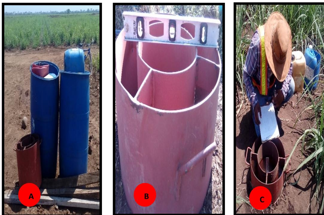
**Figura 4.** Realización de la prueba de infiltración por el método de doble cilindro, A: materiales utilizados. B: nivelación del doble cilindro. C: obtención de la lectura de infiltración.
