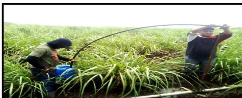
**Figura 8.** Captación del agua de un aspersor con la ayuda de una manguera, hacia una caneca, como parte del aforo.
