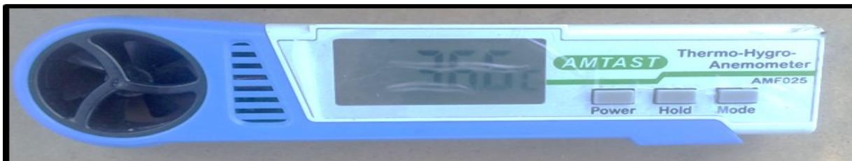
**Figura 11.** Anemómetro marca AMTAST utilizado para medir el viento (km/h), temperatura (°C), humedad relativa (%), en la evaluación de riego.
