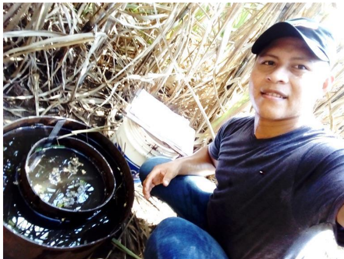
Figura 17. Prueba de infiltración básica.
