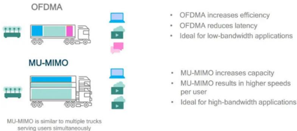
Figura 20. Comparación de OFDMA y MU-MIMO
