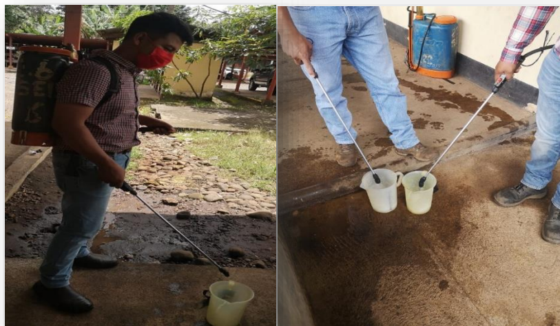
Figura 3: Aplicación de bomba para cálculo del volumen de descarga.
