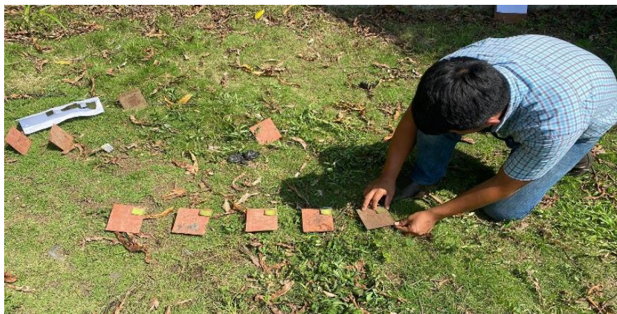
Figura 4: Distanciamiento y posición de tarjetas hidrosensibles.
