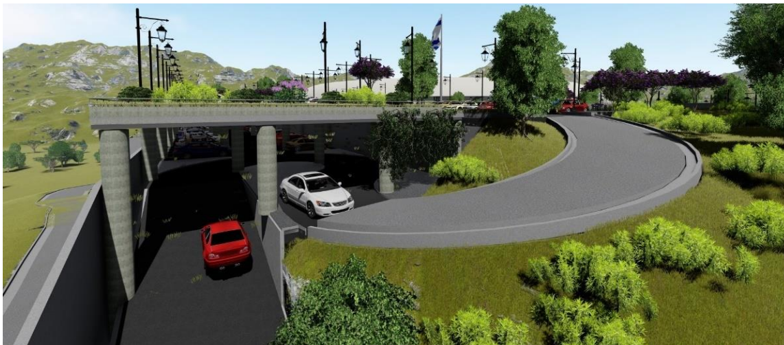
Vista arquitectónica del parqueo norte mostrando la utilización de terrazas para extender el área de parqueo. (cambio de nivel de 4 m utilizando una rampa de 20%). Fuente: elaboración propia.
