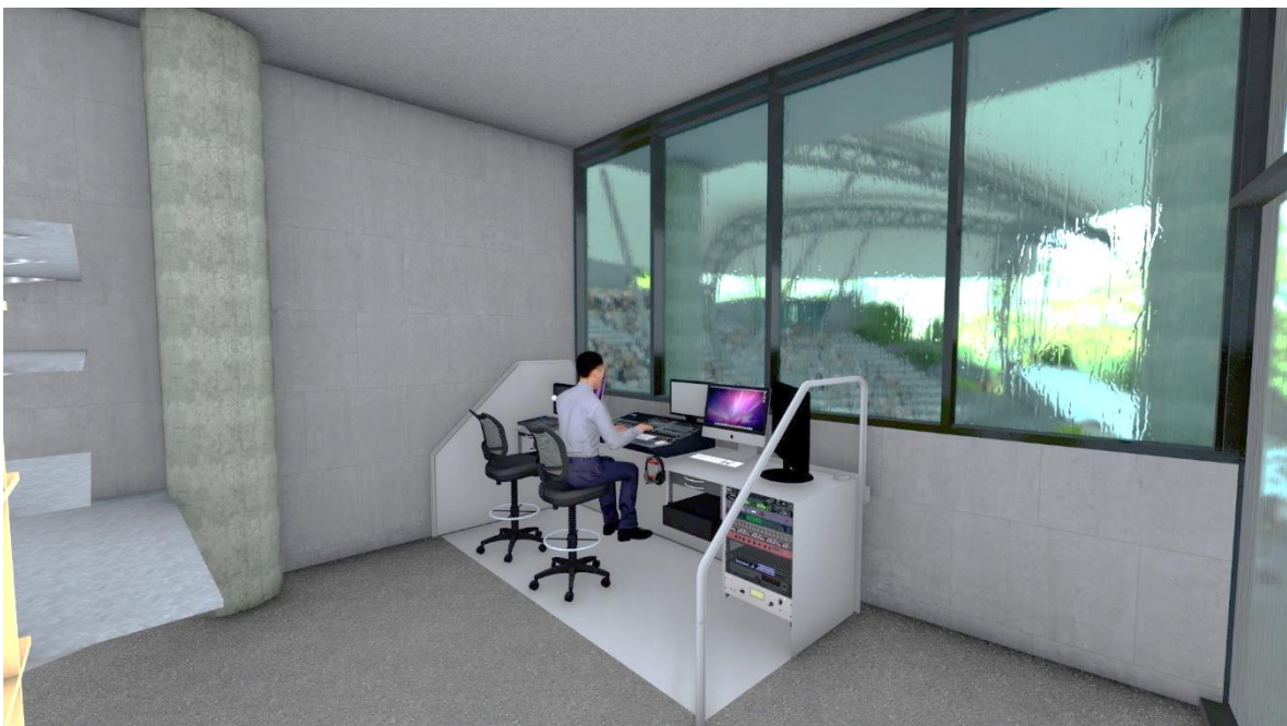
Vista interior de la cabina de sonido, posee visual directa al escenario. Esto permite la visualización y comunicación directa con los actores y necesidades que resultasen en el escenario. Fuente: elaboración propia.
