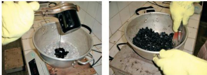
Figura 748 - 9. Adición del asfalto a los agregados y mezcla manual sobre una placa calefactora
