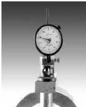
Figura 748 - 7. Deformímetro para medir el flujo
