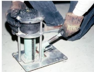
Figura 748 - 11. Extracción de la probeta
