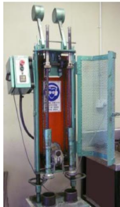
Figura 748 - 4. Compactador Marshall doble
