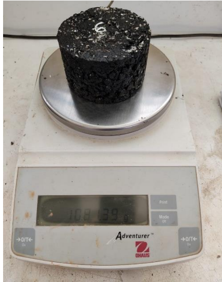
Figura 9. Toma de dato de masa de probeta en aire
