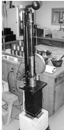
Figura 748 - 3. Martillo mecánico de compactación Marshall
