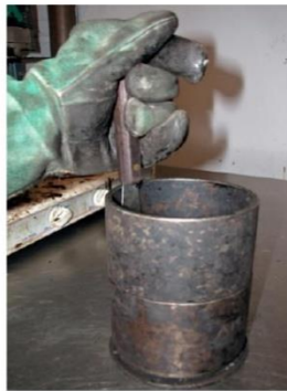
Figura 748 - 10. Golpes con la espátula a la mezcla dentro del molde
