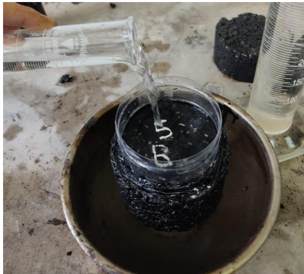
Figura 13. Prueba de permeabilidad
