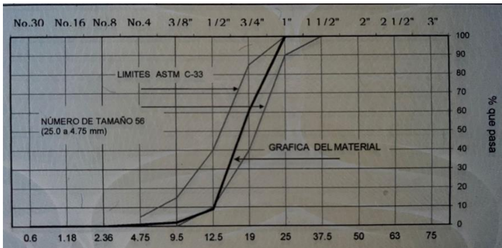
Figura 6. Curva granulométrica del agregado grueso (punto 2)
