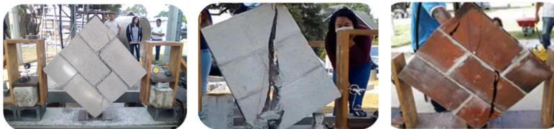
Falla en la unión mortero mamposte.
