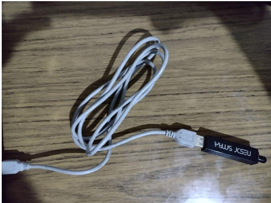
Figura 65. Conexión de RTL-SDR con extensión USB
