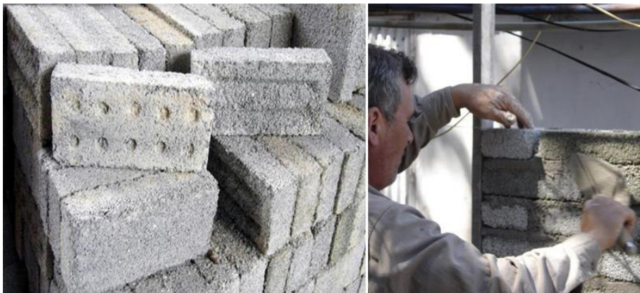
Figura 5. Ladrillo PET construido a base de botellas de agua
