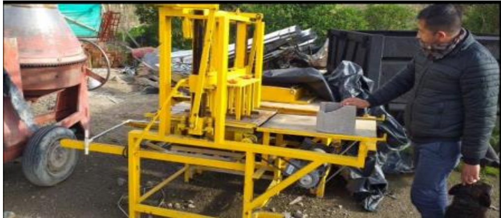
Figura 9. Máquina de trenzado para la elaboración de ladrillos ecológicos
