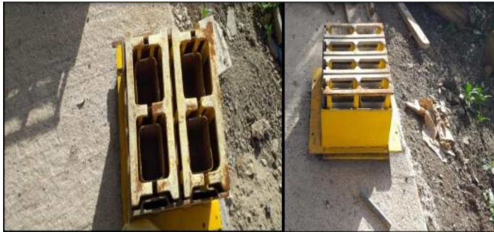
Figura 10. Moldes para ladrillo prensado
