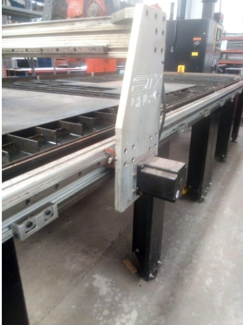
Figura 7. Eje Y de mesa CNC
