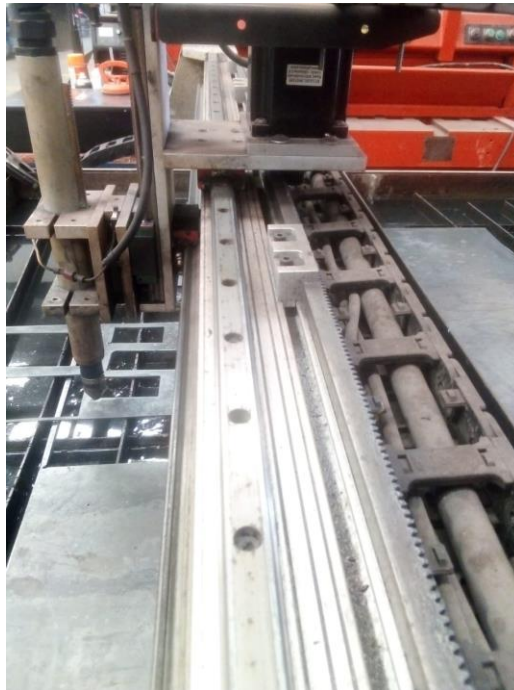
Figura 8. Eje X de mesa CNC
