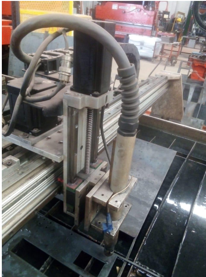
Figura 9. Eje Z de mesa CNC
