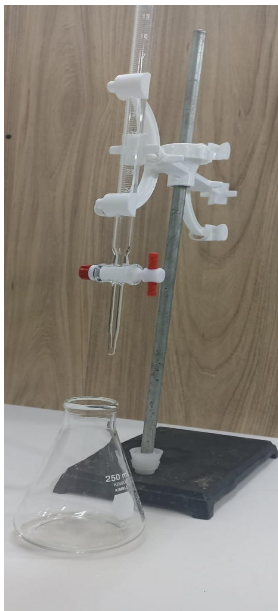
Figura 12. Forma de colocar el sistema de valoración para la práctica de cinética y equilibrio químico
