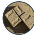
Eco-bloques de fibra de cáñamo. Monika Brummer - Alemania.
