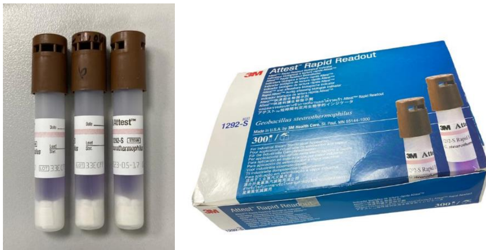
Figura 17. Indicadores biológicos de lectura rápida (marca 3MTM Attest™ modelo 1292-S)
