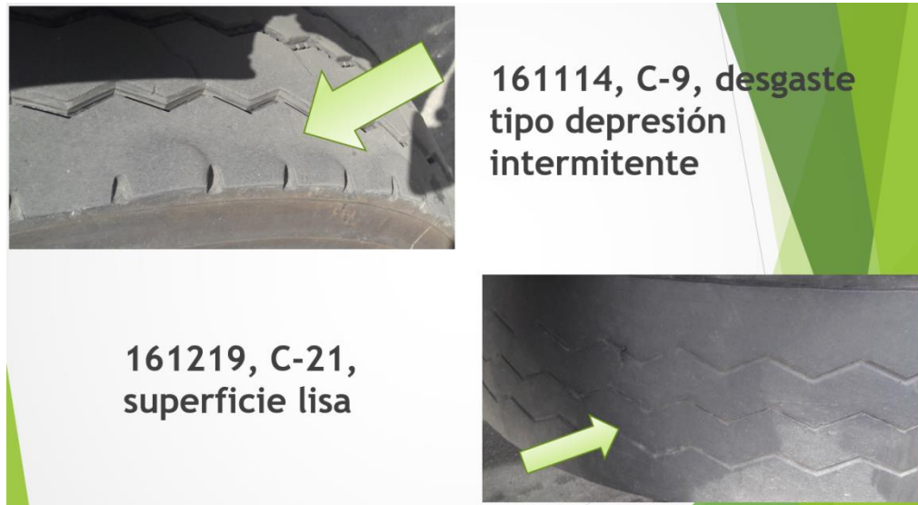
Figura 25. Desgaste tipo depresión intermitente y superficie lisa
