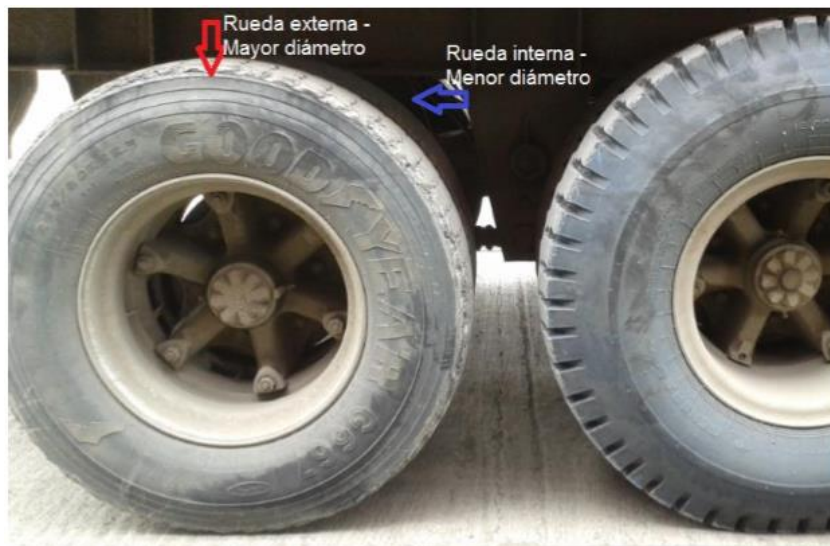
Figura 31. Fallas por fatiga en neumáticos
