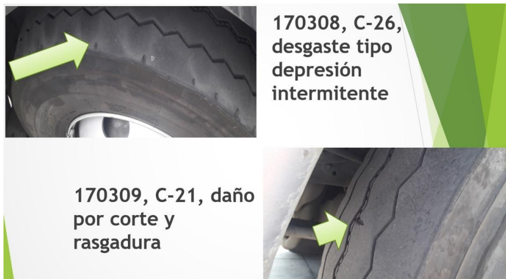
Figura 26. Desgaste tipo depresión intermitente y corte
