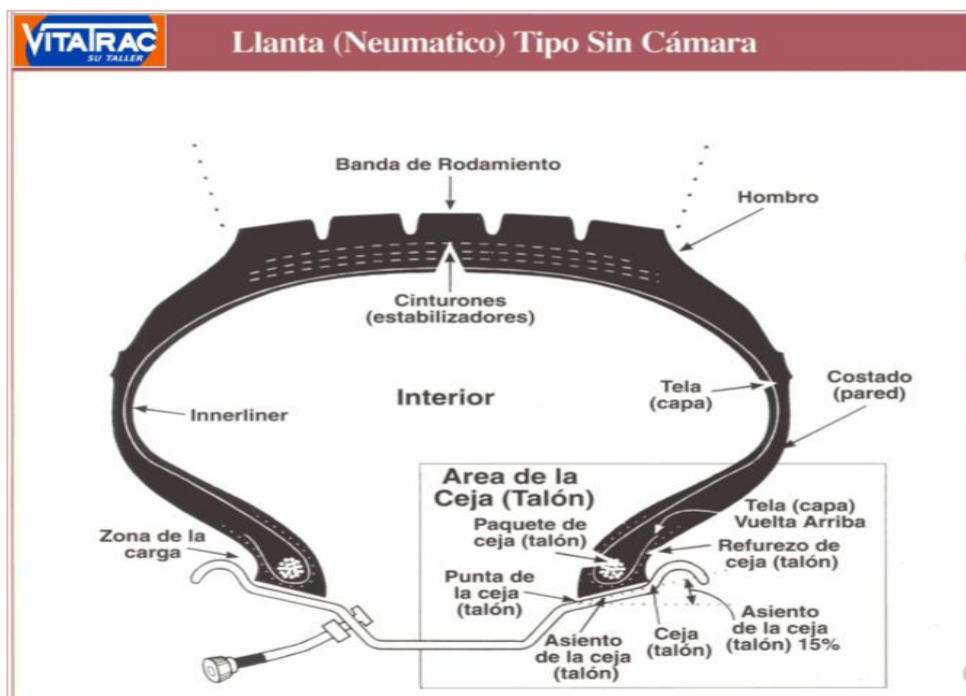
Figura 29. Áreas donde puede sufrir desgaste un neumático
