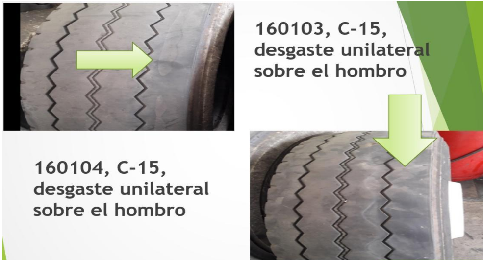
Figura 23. Desgaste unilateral sobre el hombro
