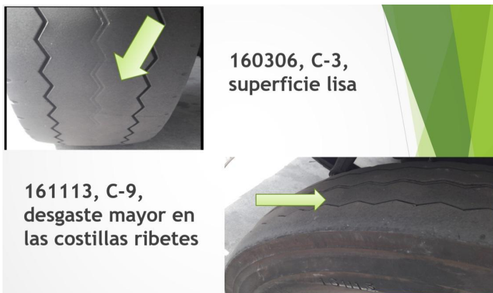
Figura 24. Superficie lisa y desgaste en costillas
