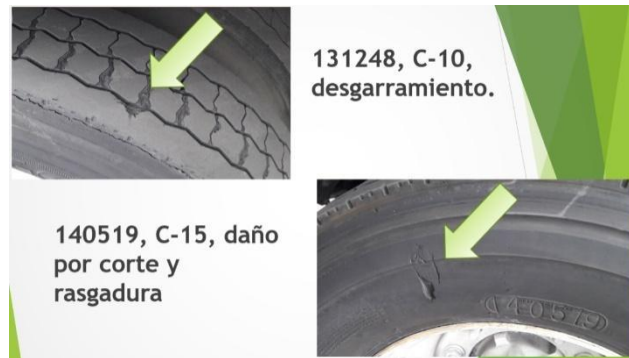
Figura 21. Desgarramiento y daño por corte y rasgadura
