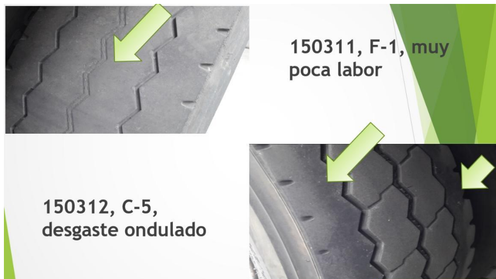
Figura 22. Poca labor y desgaste ondulado
