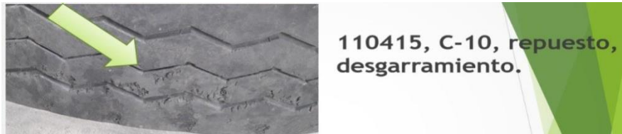
Figura 15. Falla por desgarramiento
