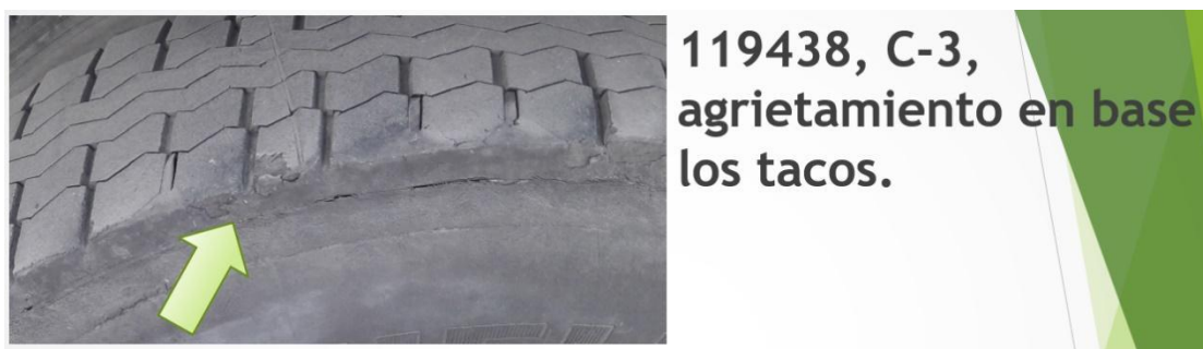
Figura 17. Daño por agrietamiento
