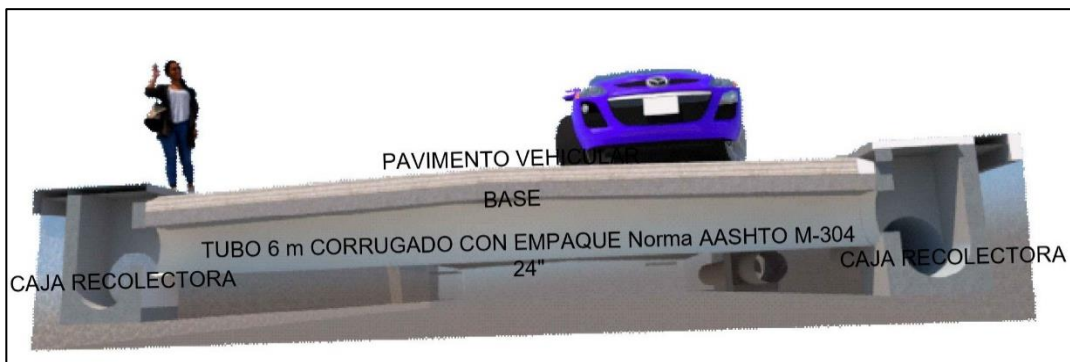
Figura 9. Propuesta de drenaje longitudinal
