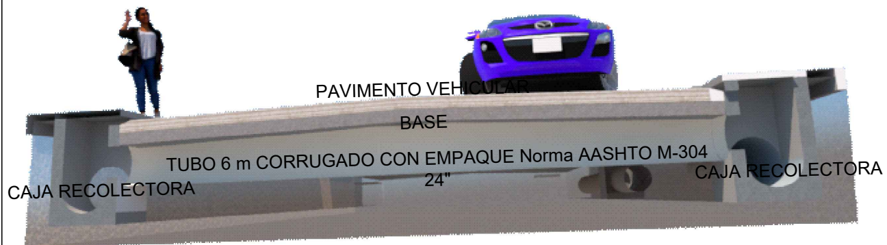
PERSPECTIVA DRENAJE PLUVIAL
