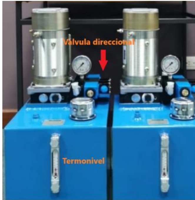
Figura 118. Unidad hidráulica armada
