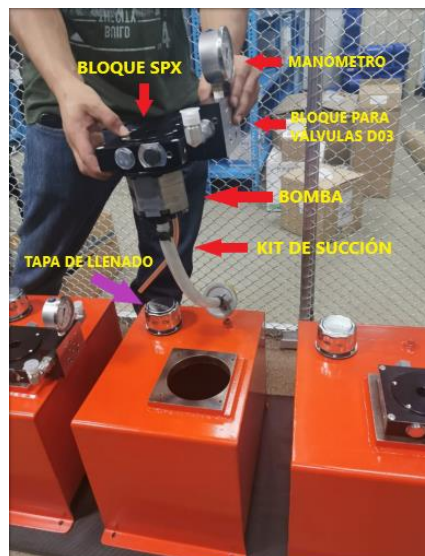
Figura 115. Componentes de la unidad hidráulica
