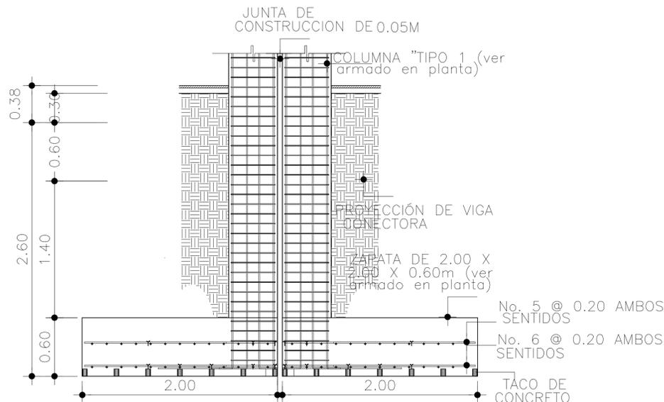
SECCION "A" ZAPATA Z-2
