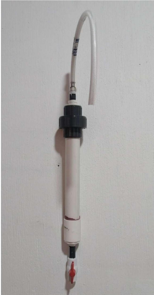
Figura 17. Tanque suavizador práctica AC2-006
