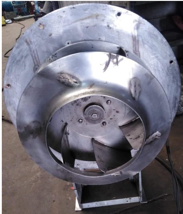
Figura 14. Ventilador centrífugo en reparación deteriorado por uso
