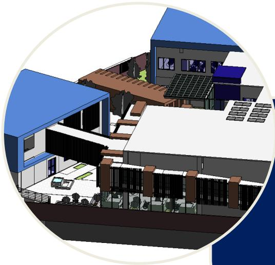
Se basó en teoría de la forma, utilizando las interrelaciones de abrazar, sustracción, continuidad. Se utilizan parteluces para mitigar el ingreso de luz, estos están colocados en rampa y ventanas. También cumplen la función de dar unidad a la forma. Se aplica el concepto de ritmo a las fachadas, cambiando los anchos de los parteluces.
