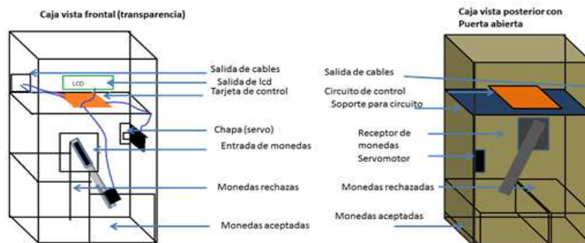
Figura 27. Ubicación de los componentes dentro del contenedor
