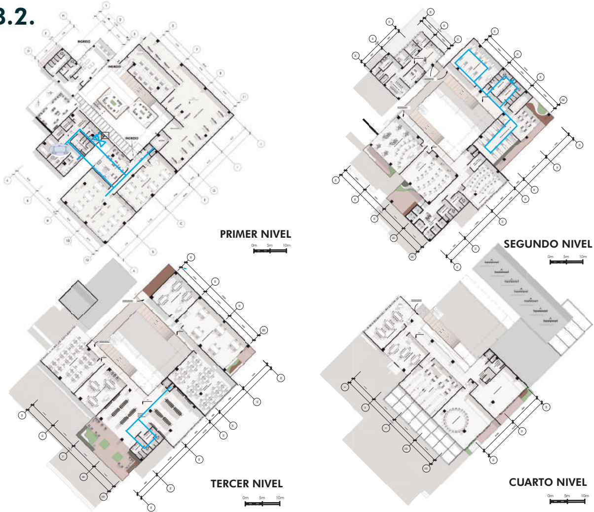
DIAGRAMA DE FUNCIONAMIENTO DE INSTALACIÓN HIDRÁULICA
