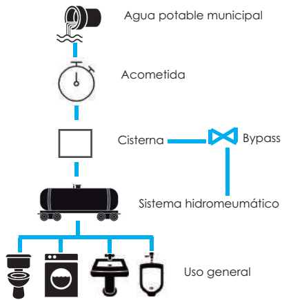
DIAGRAMA DE FUNCIONAMIENTO DE INSTALACIÓN HIDRÁULICA
