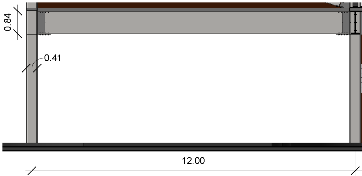
Figura 137. Elaboración propia. Imagen de un marco rígido de acero de la estructura del edificio.
