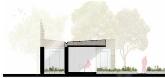
Tecnológicas constructivas: como piso utilizan bloques de hormigón de 7cm de espesor, aislados del suelo capaces de acumular el calor.
