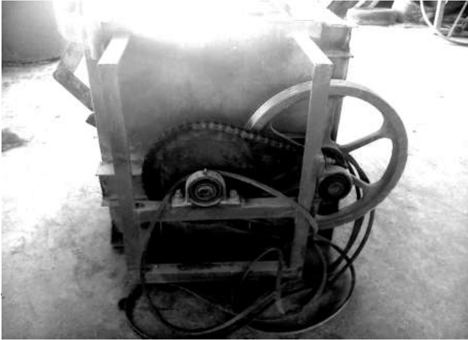
Figura 28. Reducción de velocidad, poleas y piñones
