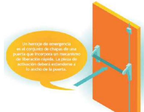
Imagen 75. Puerta de salida de emergencia. Fuente: CONRED NRD2
