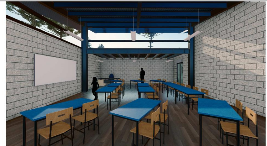
AULAS TIPO 1 Y 5 CAPACIDAD PARA 26 ALUMNOS - ABERTURAS EN PARTE ALTA PARA MEJORAR VENTILACIÓN
